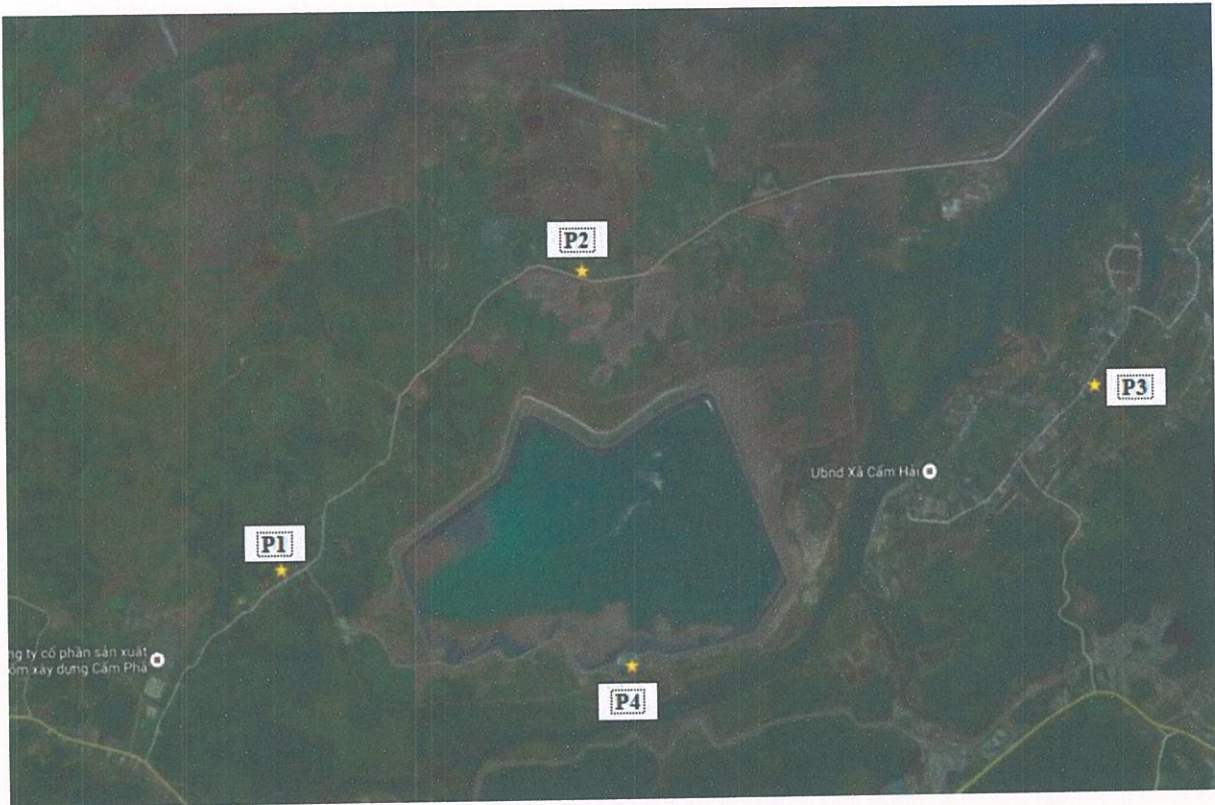
Hình 3.5. Sơ đồ lấy mẫu nước ngầm
