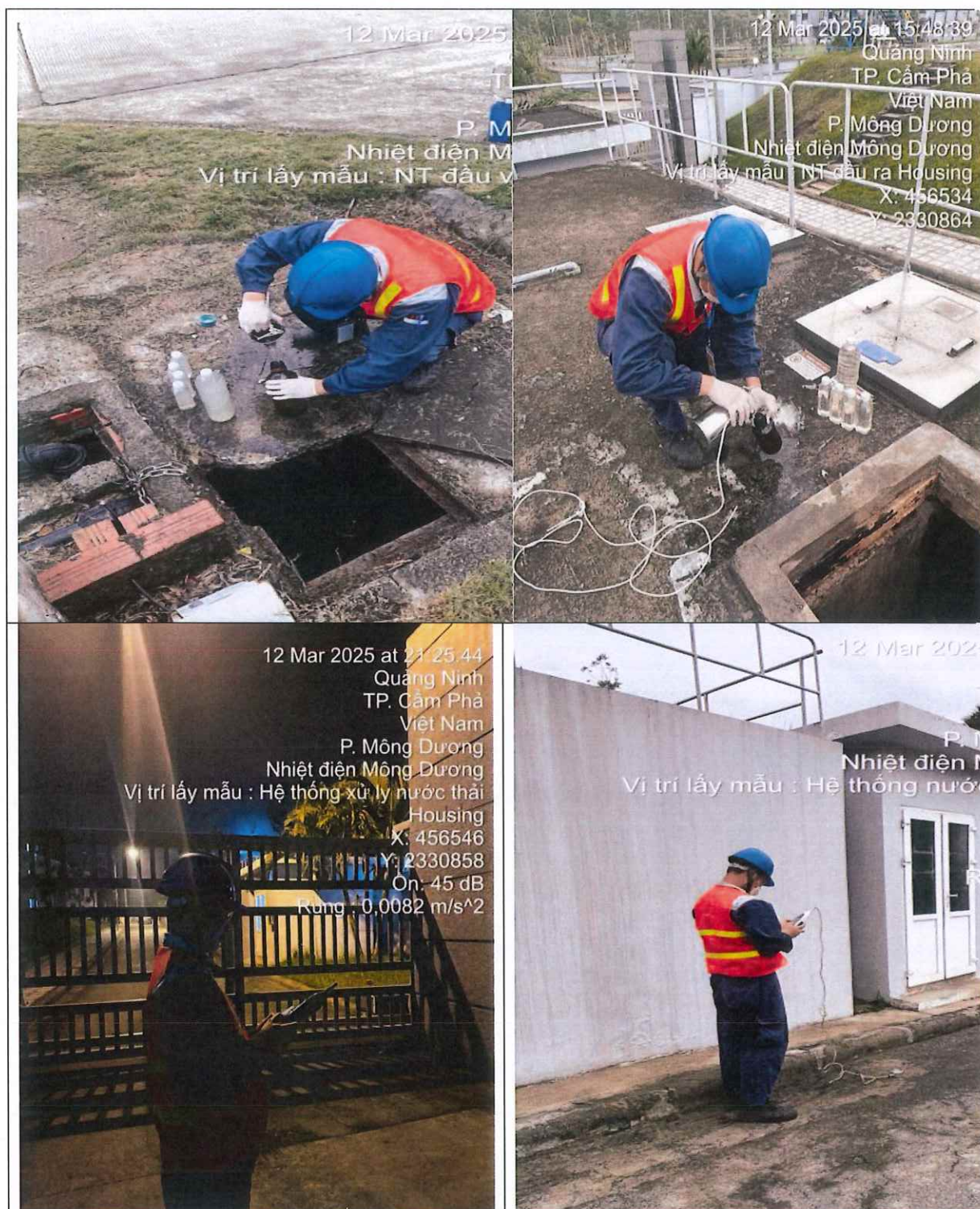
Hình 4.6. Đo tiếng ồn, độ rung và lấy mẫu nước thải -Trạm XLNT tại nhà ở chuyên gia
