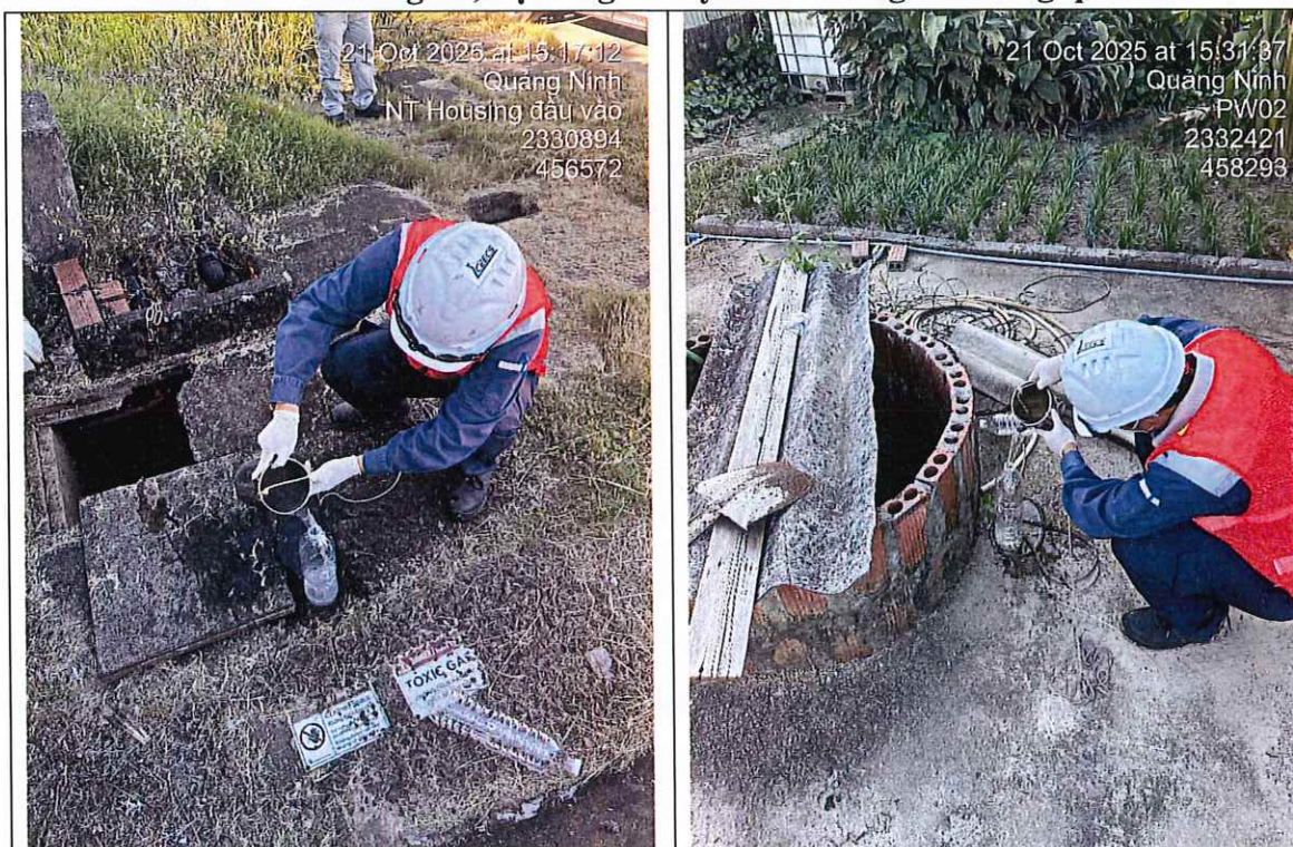
Hình 4.2. Đo tiếng ồn, độ rung và lấy mẫu không khí xung quanh
