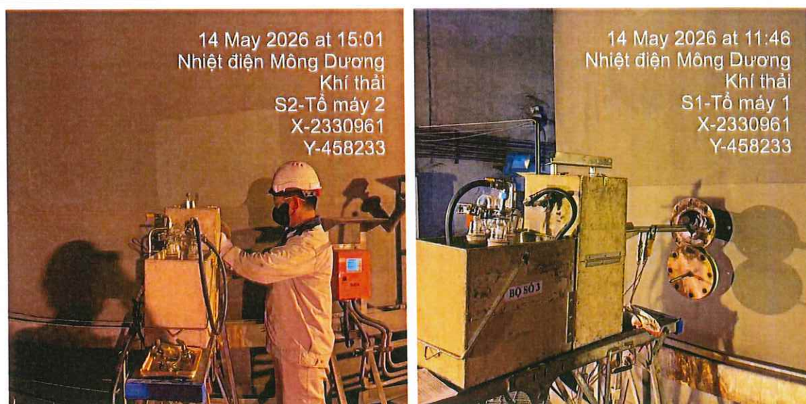
Hình 4.3. Lấy mẫu khí thải trong nhà máy
